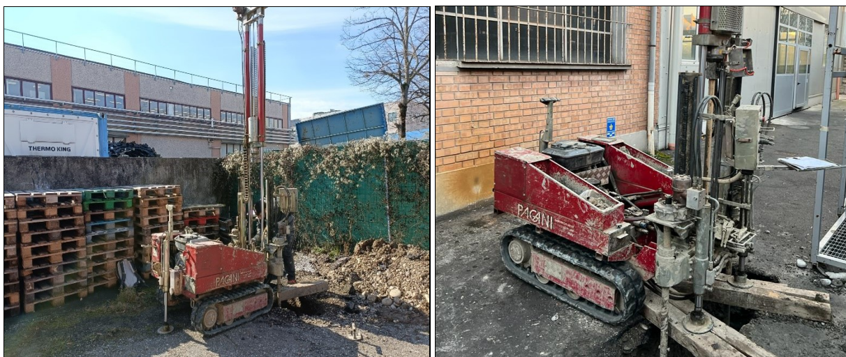
Figura 7e-f: immagini della prova penetrometrica CPT5 e CPT6
